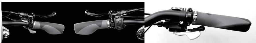
如果您拉煞车控制杆至手把，用力煞车时，您不能将它的煞车力加到全满。它将导致煞车的距离增加，会有意外的危险。请依据以上所述的调整煞车杆。
