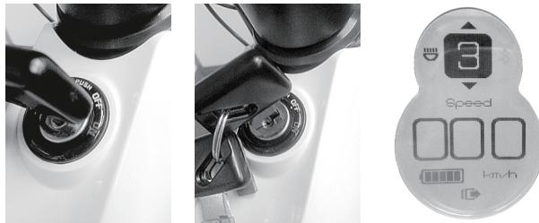
**ON:** Verificare che la batteria sia stata installata e l'avviamento della batteria si trovi in posizione "Rosso On"; si può quindi verificare che il pannello di controllo si sia acceso e che se il sistema si sia avviato. Quando nel pannello di controllo appare la schermata principale come nell'immagine, è possibile visualizzare il livello di assistenza del motore elettrico, il livello della batteria, il chilometraggio totale e la velocità.
