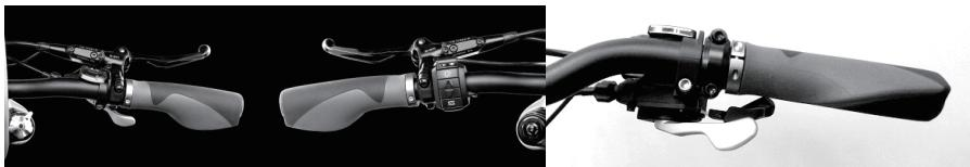
如果您拉煞車控制桿至手把，用力煞車時，您不能將它的煞車力加到全滿。它將導致煞車的距離增加，會有意外的危險。請依據以上所述的調整煞車桿。
