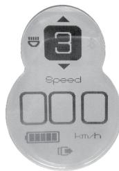
**开启：**请确认电池安装在车上并将电池锁转至“红色ON”位置，可看见仪表显示，确认系统是否开启。
